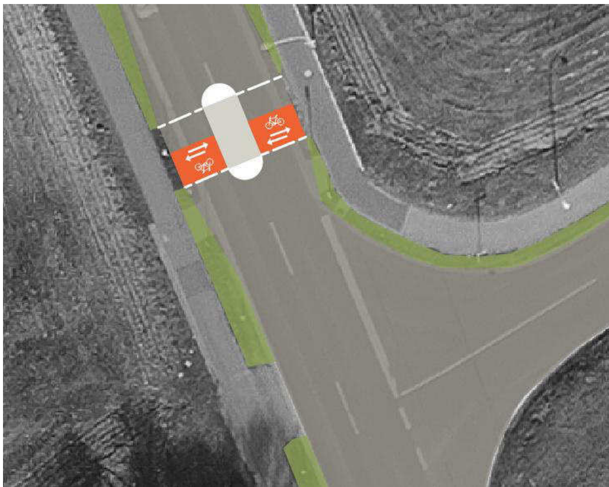
Abbildung 28: Empfohlene Querung der Reckenfelder Straße, Höhe Im Holtkamp (eigene Darstellung)
