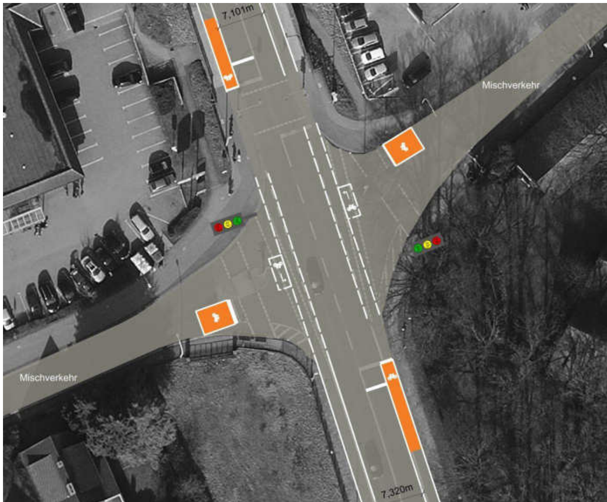
Abbildung 22: Empfohlene Knotenpunktgestaltung am Nordring/Im Hagenkamp
