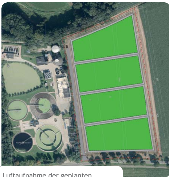
Luftaufnahme der geplanten Klärschlammvererdungsanlage.
